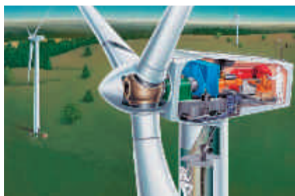
Abb. 2: Windkraftanlage mit offener Maschinengondel (siehe Anhang; Quelle: www.stromonline.ch )
